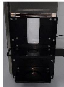
Entfernen der RAL9003-P Kunststoffkarte aus der Kalibrierkartenaufnahme und Einführen der RAL9002-P Kunststoffkarte in die Kalibrierkartenaufnahme. Nach zweimaligem Anklicken des OK Buttons wird nun auf die RAL9002-P kalibriert, d.h. die Software übernimmt die  $L^*a^*b^*$  Werte vom File *RAL Plastic Plate measured with Hunter Lab – 45°\_0°* und trägt diese in die SETVALUE TABLE sowie
