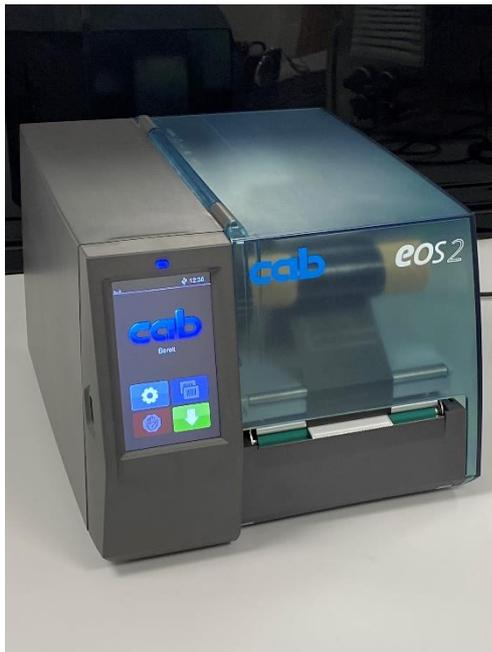
Als Etikettendrucker wird ein Drucker vom Typ „cab eos2“ eingesetzt. Der Etikettendrucker ist dabei werkseitig so voreingestellt, dass sowohl Schnittstellentreiber, das Etikettenformat und die Etikettenrolle für diesen Anwendungsfall passen. Der Etikettendrucker ist über ein USB-Schnittstellenkabel mit der Auswerteeinheit verbunden.
